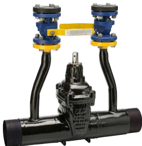
Серия 46/80 Задвижка клиновая с длинными патрубками и двумя отводами для продувки DN80-600 PN16 GP240GH Наружное покрытие PUR
