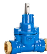
Серия 03/65 Задвижка ответвительная со сменными муфтами для ПЭ труб DN25-50 PN16 Высокопрочный чугун
